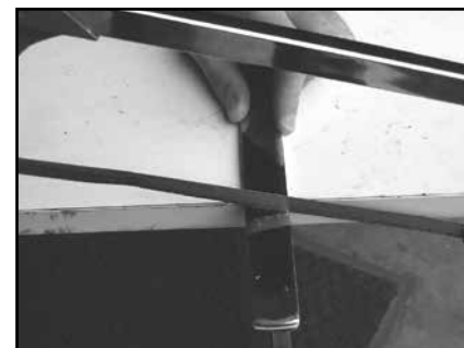
Couper à 15 mm (minimum) sous le trou et ébavurer la coupe. Cut at 15 mm (minimum) under the hole and trim smooth.
