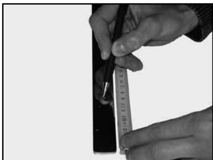
Tracer à la hauteur choisie. Mark according to drum height.
